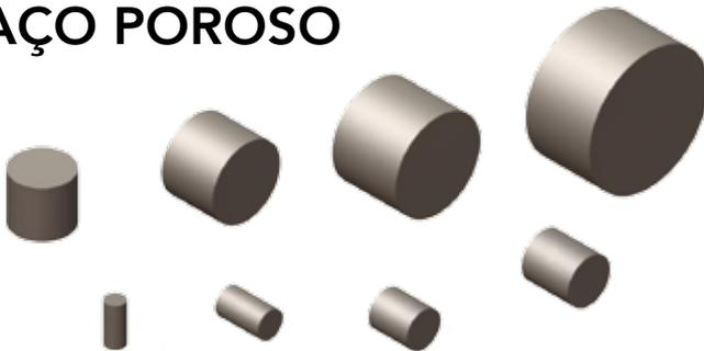
O inserto de AÇO POROSO é utilizado para locais onde existe um acúmulo de gás, linhas de preenchimento e dificuldade de emenda. Assim possibilitando uma pressão de injeção melhor, evitando o estresse do material plástico, consequentemente aumentando a produção.
